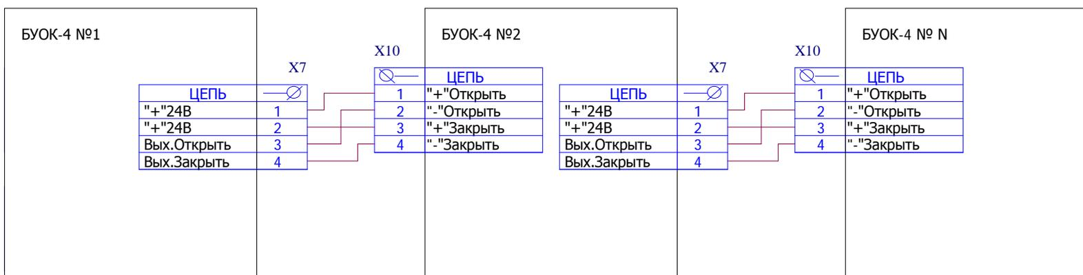
Рис. 12. Схема соединения блоков БУОК в группу
